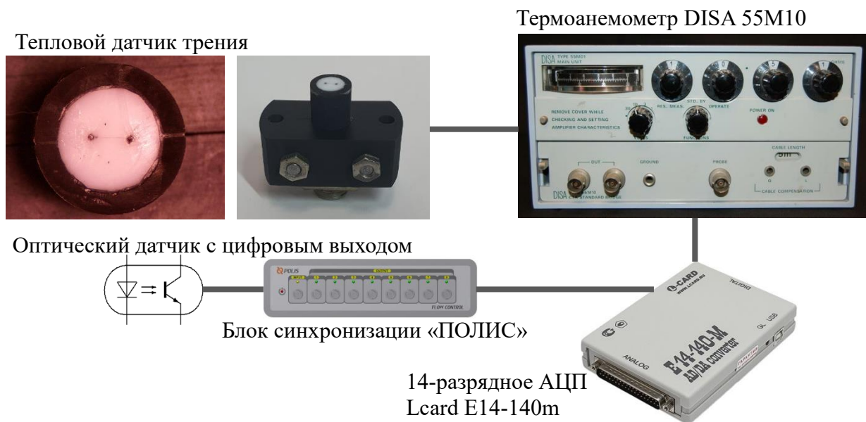
Рис. 2.3.2. Фото теплового датчика трения и схема синхронизации при записи пульсирующего режима потока.
