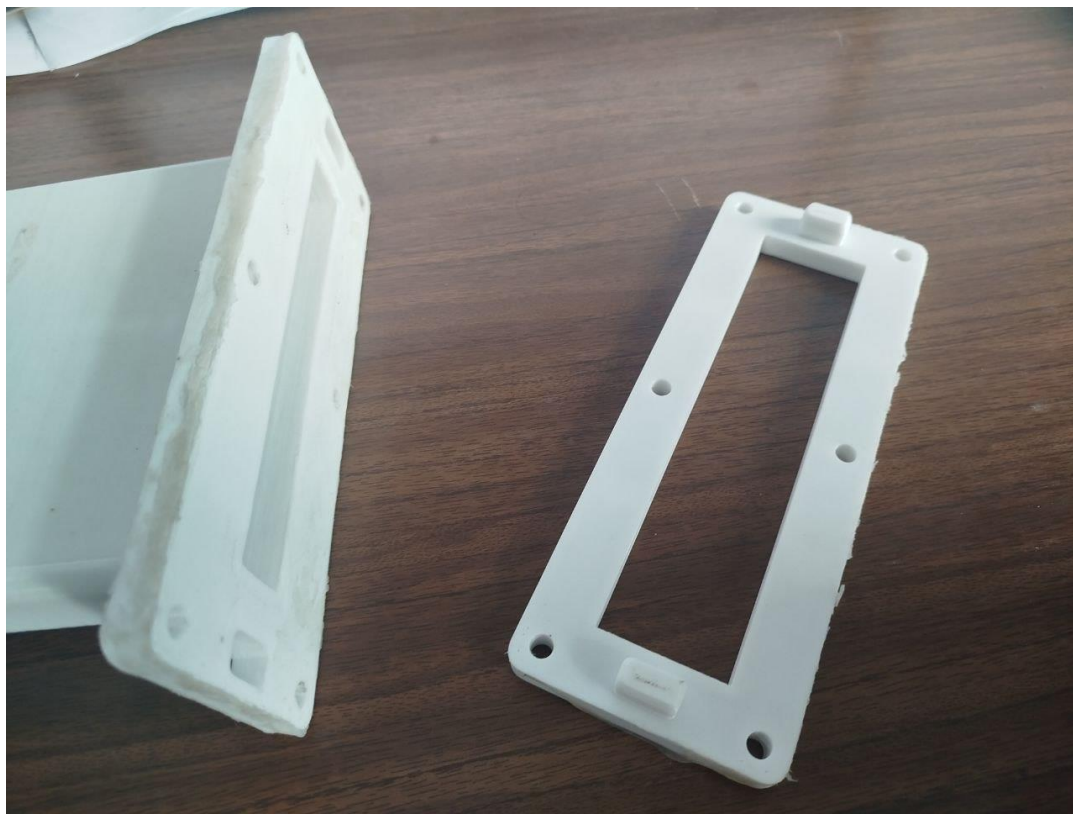
Рис. 2.1.2. Фото замковых соединительных фланцев размеченных на 3д принтере.
