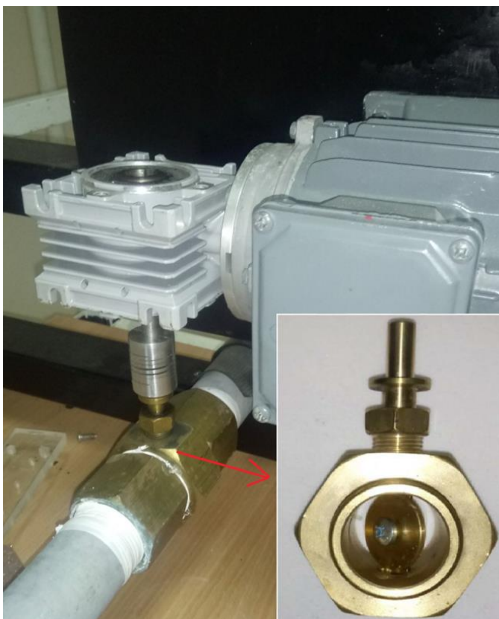
Рис. 2.1.5. Конструкция заслоночного пульсатора из работы [11].
